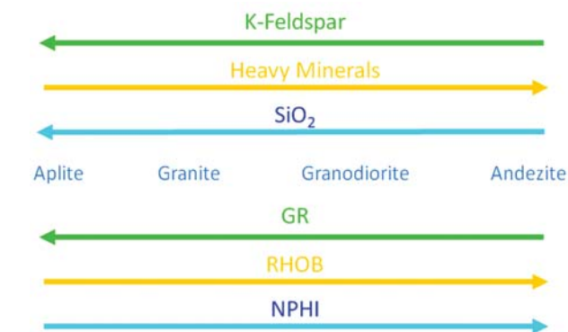
Hình 3. Đặc trưng đường cong địa vật lý giếng khoan đối với từng loại đá
